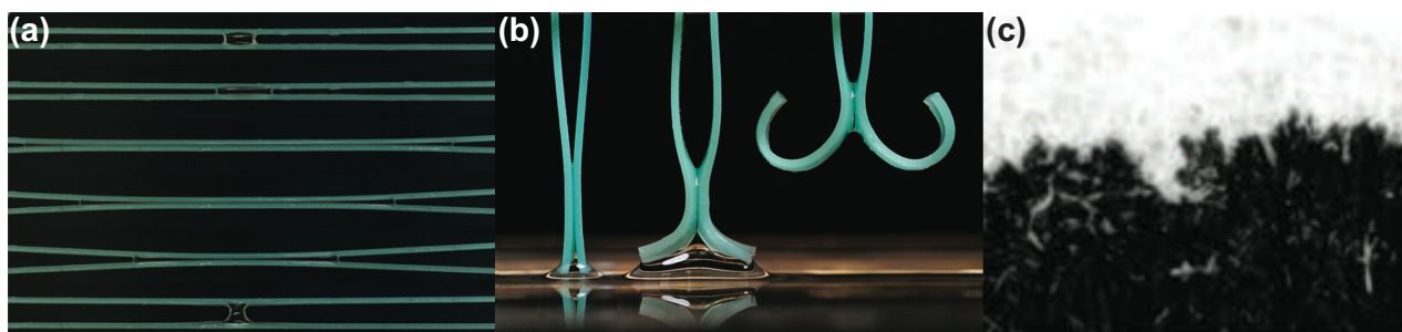
Fig.: Expériences modèles de mouillage de fibres flexibles (a) et de gonflement de plaques d'élastomère (b). (c) front d'imprégnation dans du papier.
