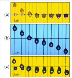
Figure 1 : Microfluidique sur fibre. (a) mélange (b) division (c) encapsulation. Photographies issues de [4].
