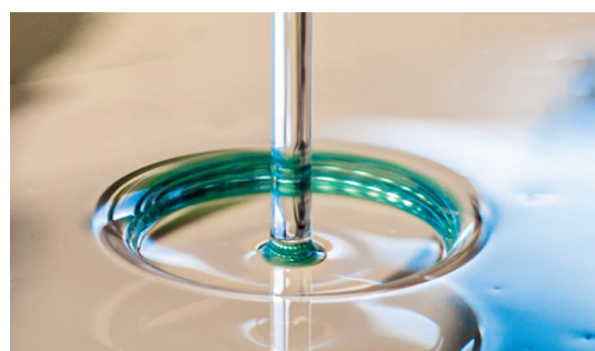
En haut : impact d'un micro jet sur une surface super hydrophobe. En bas : ressaut circulaire hydraulique d'huile silicone.
