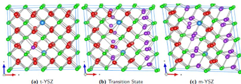
*Schéma d'une transformation de phase solide-solide dans la zircono yttrioé(YSZ) .les atomes Zr, Y et O sont respectivement représentés en vert, bleu et rouge, le violet correspond à des oxygènes trivalents . À gauche la phase tétragonale(t), à droite la phase monoclinique(m), après transformation.*
